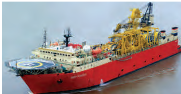
Exemplo de um navio de Colocação de Tubos Flexíveis e Umbilicais
