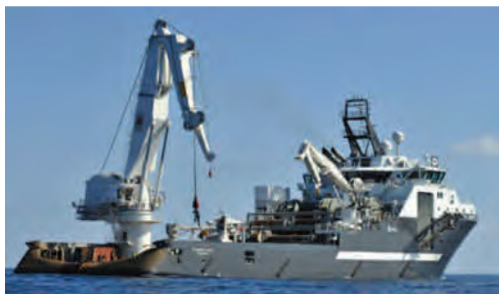
Exemplo de um navio de Colocação de Tubos Flexíveis e Umbilicais
