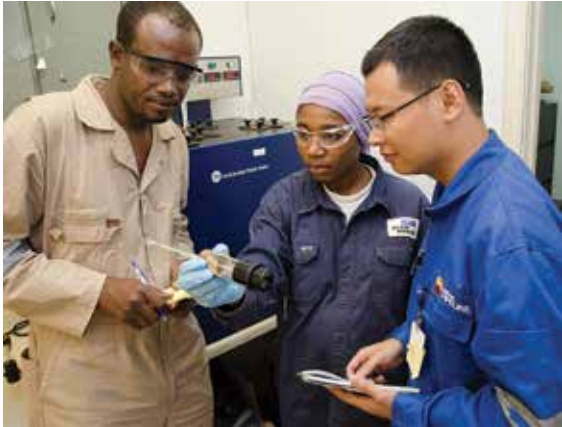
Salamatou Hissein, chez le sous-traitant Baker Hughes, effectue un test pour déterminer le point d'écoulement du brut pendant que des ingénieurs du Ministère du Pétrole Tchadien et l'expéditeur CNPCIC observent.
